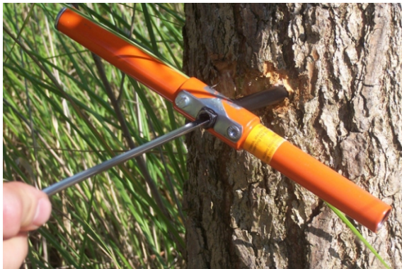
Bohrkernentnahme mit einem Zuwachsbohrer
